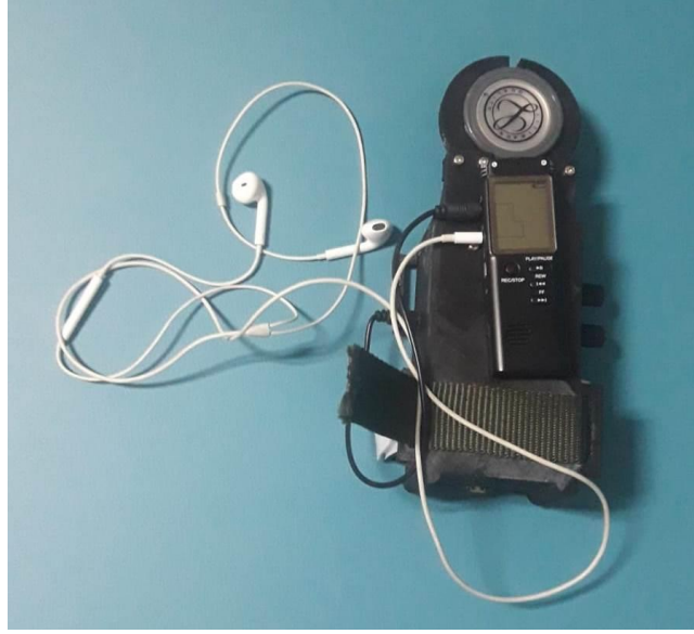
Şekil 2.2. Çalışmada kullanılan gastrointestinal aktivite akustik izlem cihazı
